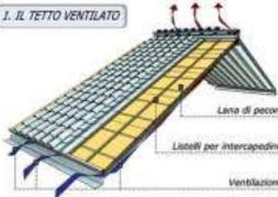
In questo tipo di tetto il manto di copertura si distacca dallo strato isolante, creando un'intercapedine che permette ad un flusso omogeneo d'aria, di circolare dalla grande fino al colmo; conseguentemente, devono essere evitate cornici trassveriali.
