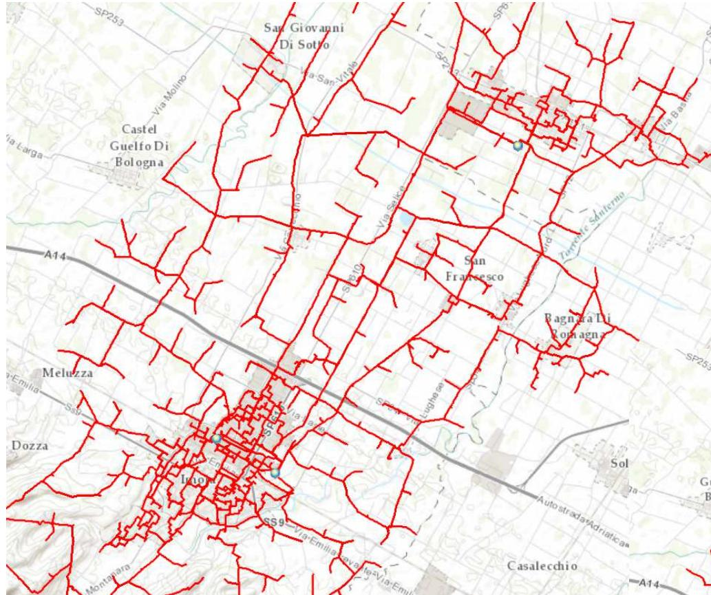
Rete di distribuzione in media tensione (in rosso) di Imola con linee aeree e cavi di lunghezza complessiva di circa 200km con tre cabine primarie (pallini blu) ognuna con 2 trasformatori da 30 MVA.
